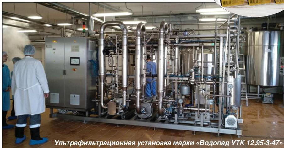
Ультрафильтрационная установка марки «Водопад УТК 12,95-3-47»
