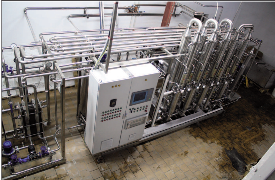
Установка марки «ВОДОПАД» 36,15-4-138» производительностью 580 кг творога в час (г. Саратов, ООО «Комбинат детского питания») и продукты, вырабатываемые на установке
