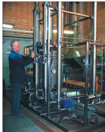
Установка мембранная (ультрафильтрационная) марки «ВОДОПАД УТК 24.5–3–84» производительностью 600 кг творога в час
