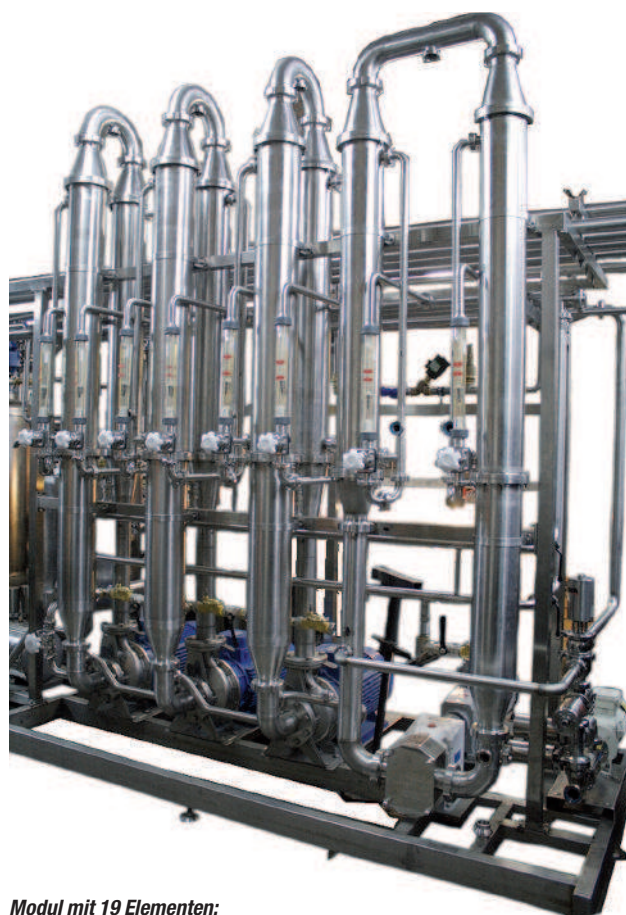
Modul mit 19 Elementen: Keramische Membranelemente A – mit hydraulischem Kanaldurchmesser 6,0 mm, B – mit hydraulischem Kanaldurchmesser 3,5 mm, Membrananlage „Wodopad MTK 36,15-4-138“ zur Produktion von 500 kg pro Stunde, Membranblock der Anlage zur Produktion von 500 kg Quark/h
