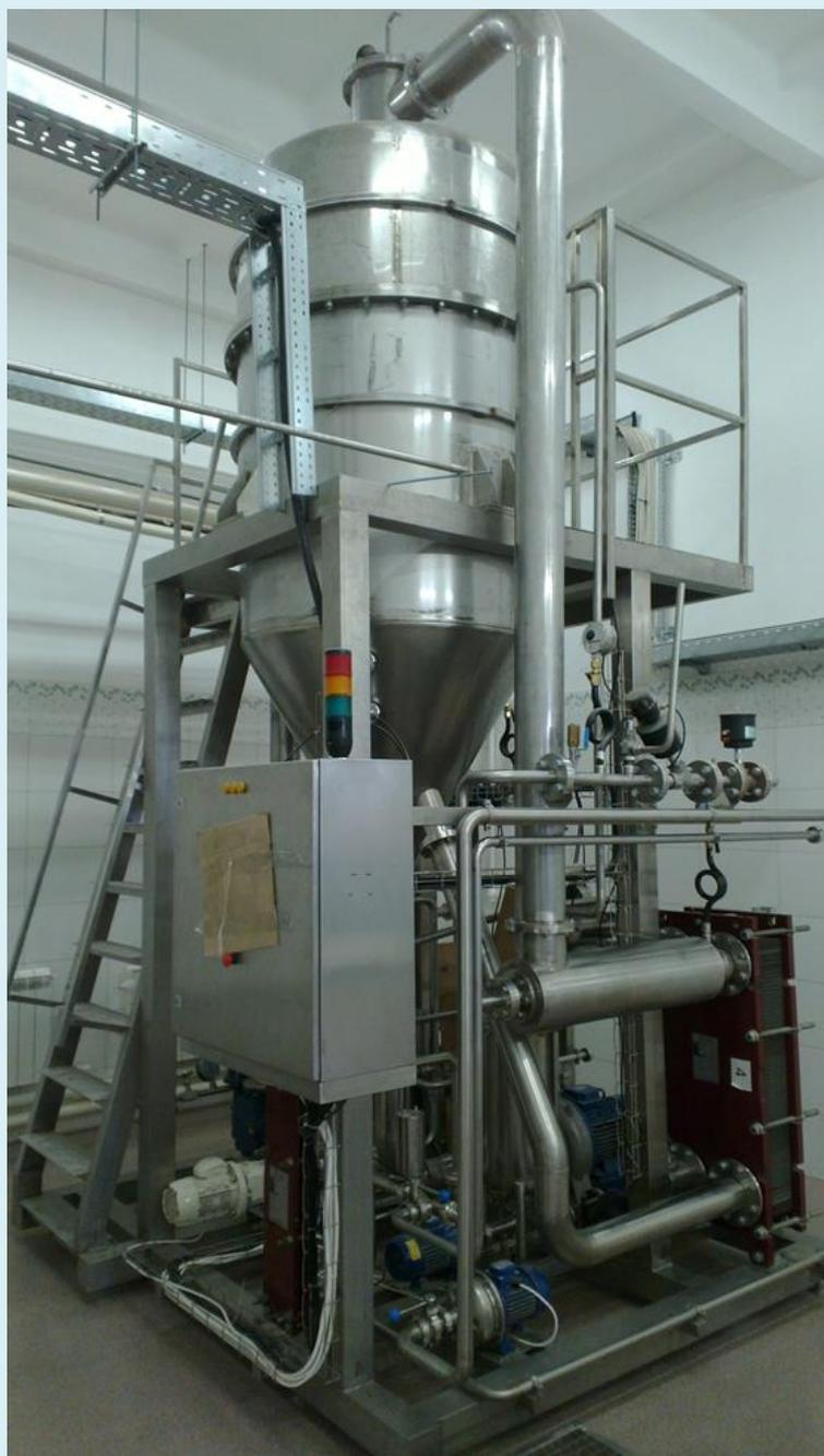
**Установка предназначена для концентрирования в непрерывном потоке различных пищевых, химических и микробиологических жидкостей, в том числе с высокой вязкостью и со склонностью к образованию отложений.**
