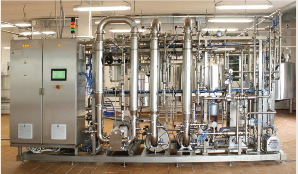
5. Установка марки "ВОДОПАД УТК 12,95-3-47", 250 кг творога в час из коровьего и козьего молока; ОАО "Сернурский сырзавод"; эксплуатируется с 2015г.
