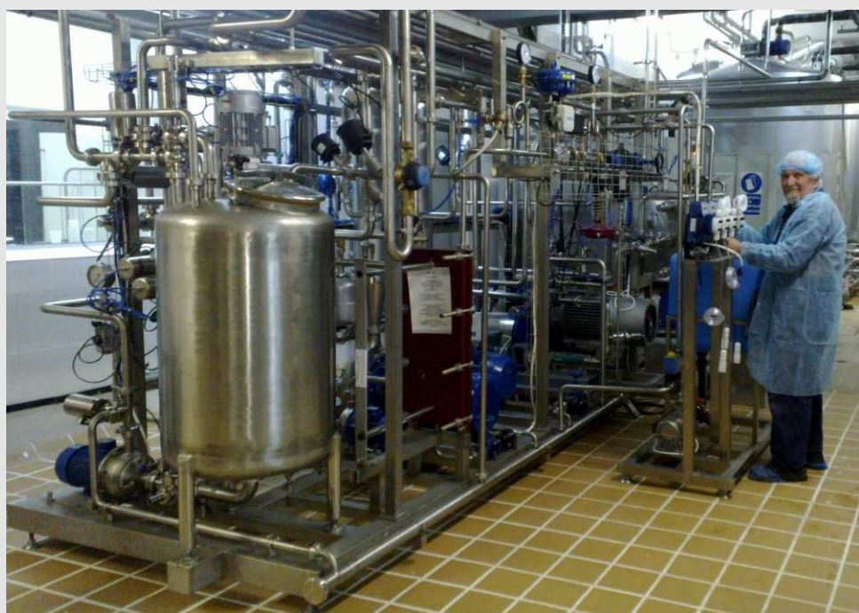
8. Установка марки «ВОДОПАД УТК 16,1-3-52», 200 кг творога в час; 200 кг концентрата кисломолочного продукта в час, 500 кг концентрата молока в час. ОАО «Рузское молоко»; эксплуатируется с 2017 г.
